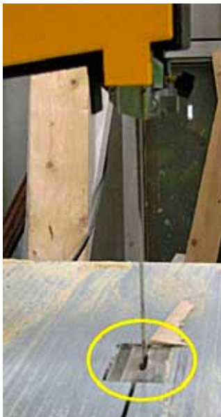
Kuva 14. Vannesahan pöydässä on terän läpimenokohdassa aukko, jossa on puinen täytepala terän koskettamisen varalta. Kun täytepalan aukko kuluu liian suureksi, tilalle vaihdetaan uusi pala.
