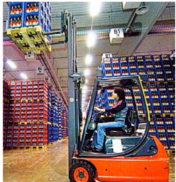
Kuva 39. Trukissa on putoavilta esineiltä suojaava turvakatos.
