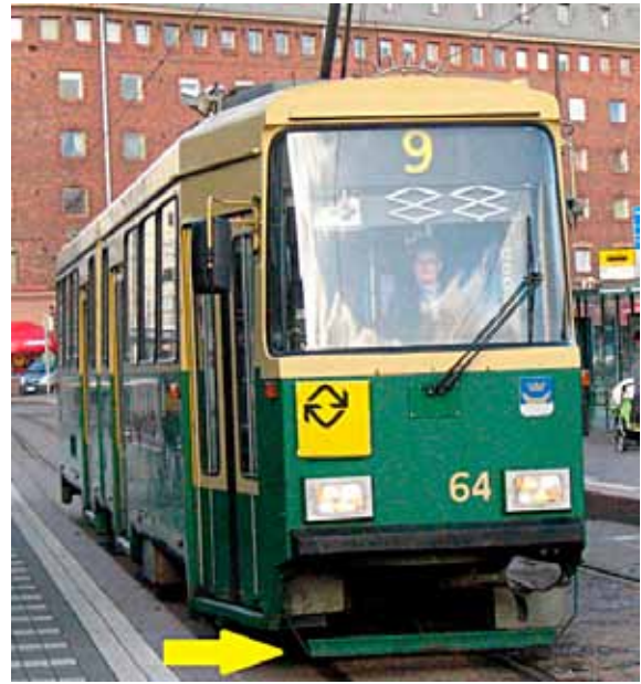
Raitiovaunun tuntopuskuri pysäyttää vaunun ennen kuin alle kaatunut henkilö joutuu pyörien ruhjomaksi.
