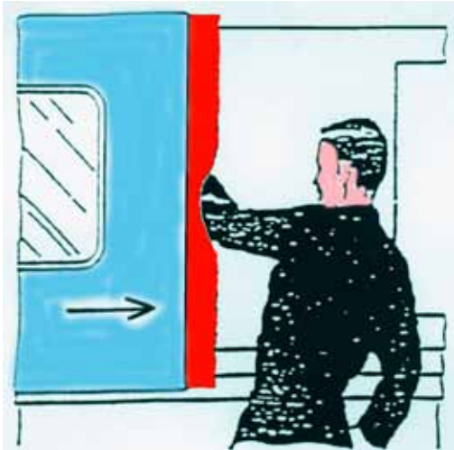
Kuva 16. Konevoimalla sulkeutuvasta suojuksesta aiheutuvaa riskiä vähennetään tuntoreunalla.
