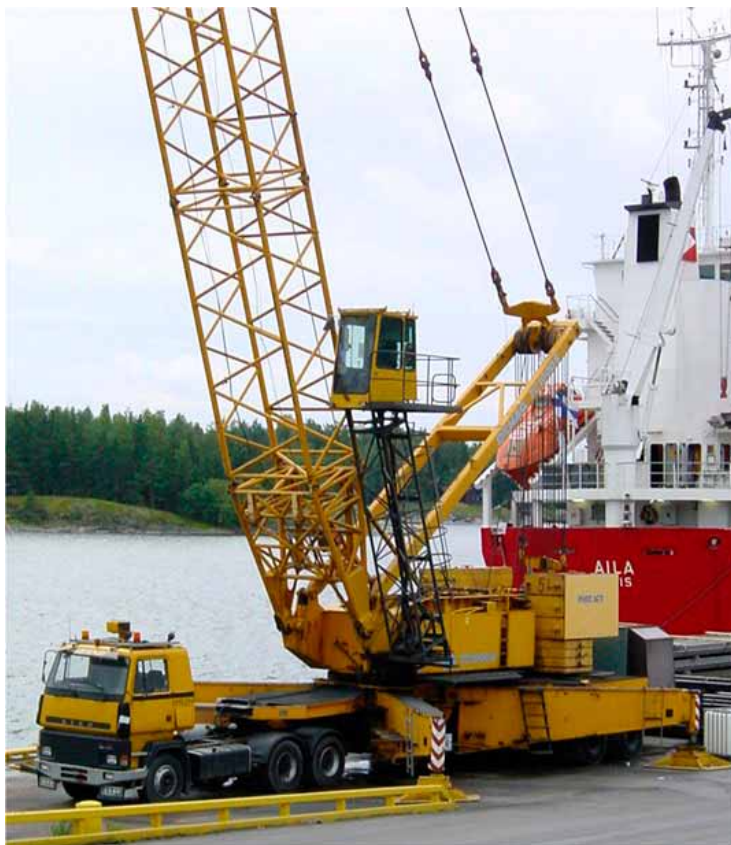
Kuva 43. Suuren ajoneuvonosturin ohjaamo on sijoitettu korkealle paremman näkyvyyden aikaan saamiseksi.
