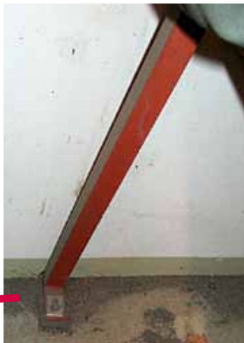
Kuva 8. Penkkihioma- koneen teline on kiinnitetty tukevasti lattiaan.
