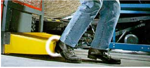
Kuva 36. Tuntopuskuria voidaan käyttää törmäyksen seurausten lieventämiseen.
