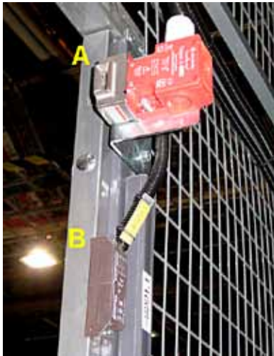
Kuva 18. Kone voidaan käynnistää vasta sitten, kun kielityyppisen asemantuntoelimen kieli on kytkimessä (A) sille tarkoitetussa kolossa ja lisäksi anturi (B) on tunnistanut yksilöllisesti koodatun vastakappaleen. Turvatoiminnon mitätöiminen ylimääräistä irtokieltä käyttämällä ei siten ole mahdollista. Kahdennus voidaan toteuttaa kahdella eri laitteella (vasen kuva) tai kaksi anturia voi olla samassa laitteessa.
