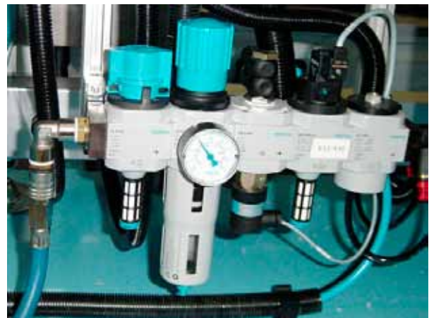
Kuva 22. Paineilman huoltoyksikössä oleva käsikäyttöinen sulkuventtiili purkaa suljettaessa paineen. Venttiilissä on paikat kahdelle riippulukolle.
