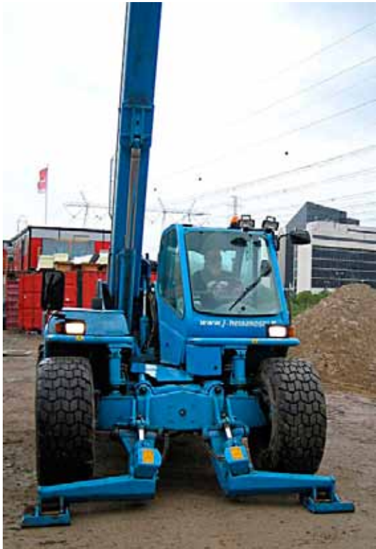
Kuva 40. Noston aikana tukijalat ovat maata vasten.
