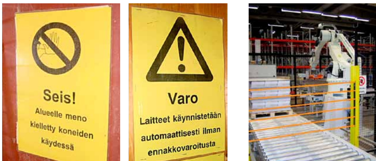
Kuva 9.a Aikaisemmin vaarallisten koneiden alueelle menemisestä vain varoitettiin esimerkiksi roikkuvien muovikettinkien tai kylttien avulla (vasemmat kuvat). Nykyisin edellytetään, että tällaisissa aukoissa on luotettava passivoitava turvalaite, joka erottaa siirrettävän tuotteen ja ihmisen toisistaan (oikea kuva).
