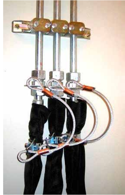
Kuva 7. Letkun päälle vedetty suojausukka hajottaa terävän suihkun vähemmän vaaralliseksi ja varmistusvaijeri estää irtoavan letkun huitaisemisen.
