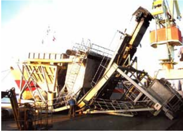
Kuva 3. Esimerkkejä riittämättömän lujuuden aiheuttamista tapaturmista.
