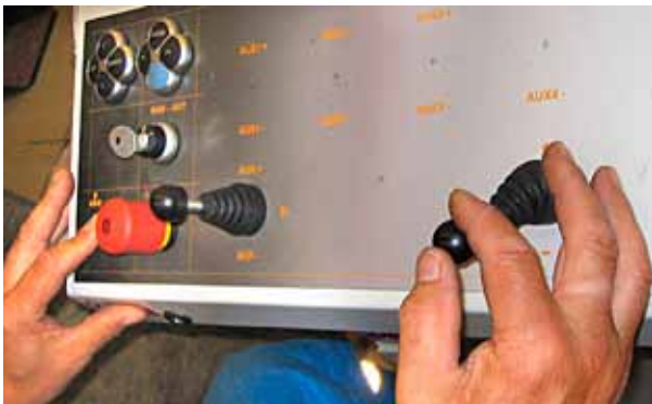
Kuva 29. Koneen liike on mahdollinen vain, kun yhtä aikaa vaikutetaan vasemman käden sormella sallintapainikkeeseen ja oikealla kädellä ohjausvipuun.
