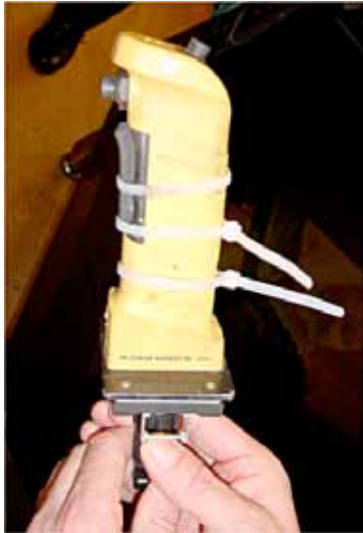
Kuva 12. VÄÄRIN. Sallintakytkintä käyttämällä koneen toimintaa voitiin tarkkailla, kun kone oli käynnissä rymintänopeudella ja suojaovi oli auki. Tällaista tarvetta oli aika usein ja melko pitkiä aikoja kerrallaan. Se johti sallintakytkimen kytkimen pakottamiseen käyntiasentoon nippusiteillä.
